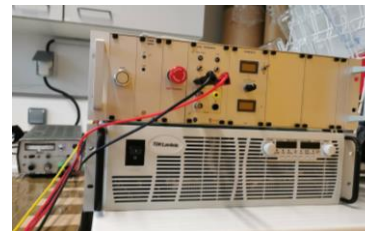
Potentiostat : -2V.-1A, 7ml/min RH 2 : 55.2% CO 2 : 8.5% R= 52%
