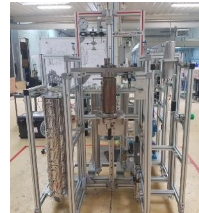
Electrolyseur : Volume 1litre – 1 tube de 30cm de long (1kW)
