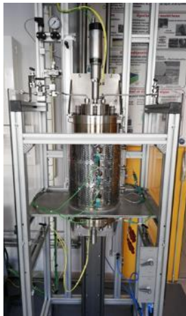
Autoclave électrochimique agité 5L 300°C-100 bars
