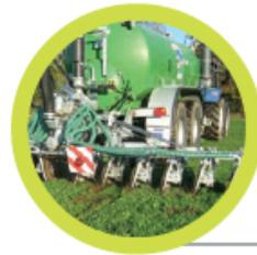
**Epandeurs avec éléments d'injection à disques espacés de 20 cm.** Créent un sillon étroit de 4 à 6 cm de profondeur où est injecté le digestat
