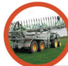
**Rampes à patin avec des sabots plaqués au sol** qui écartent la végétation pour placer le digestat (ou le lisier) au sol
