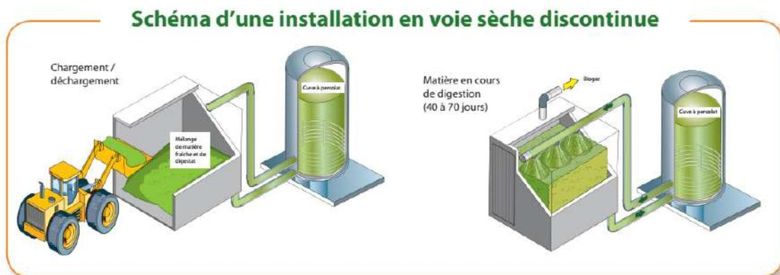
Figure 17. Schéma d'un digesteur en voie solide discontinue [17]
