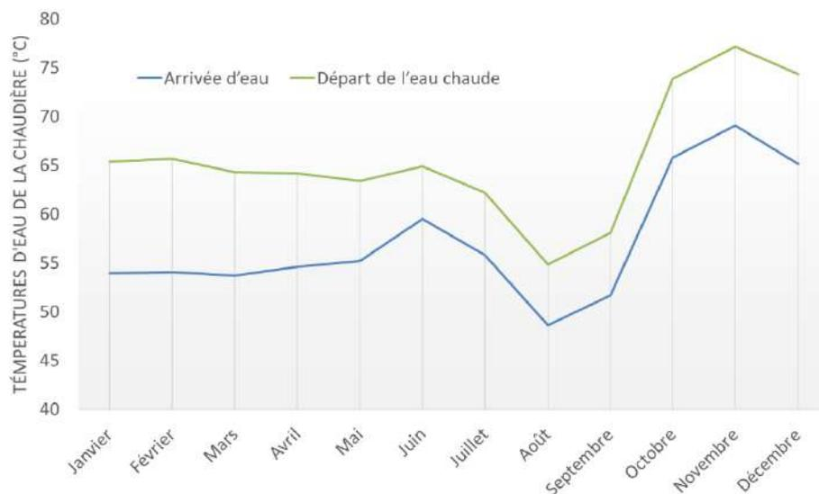
Figure 57. Profil annuel des températures d'arrivée et de départ de l'eau chaude de la chaudière à gaz
