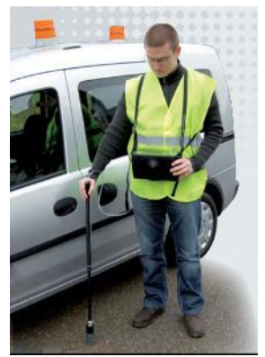
DÉTECTION LASER AVEC CANNE POUR DÉTECTION FUITES ENTERRÉES
